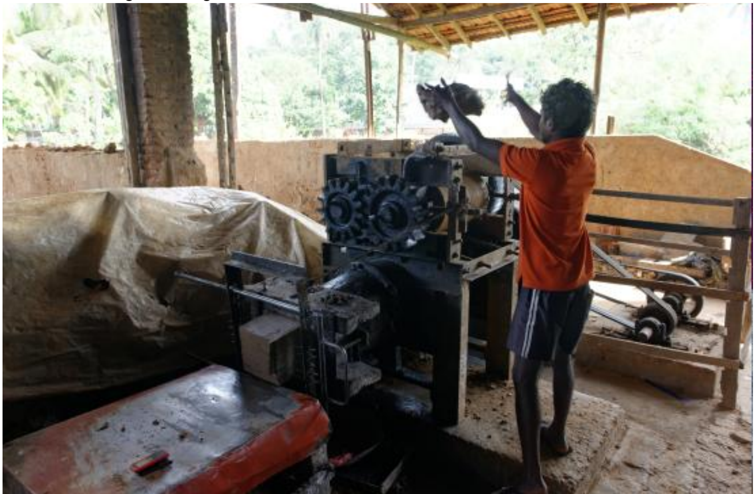
Die Personen fertigten die Ziegel. Man erkennt die Maschine in die man den Ton werfen muß.
